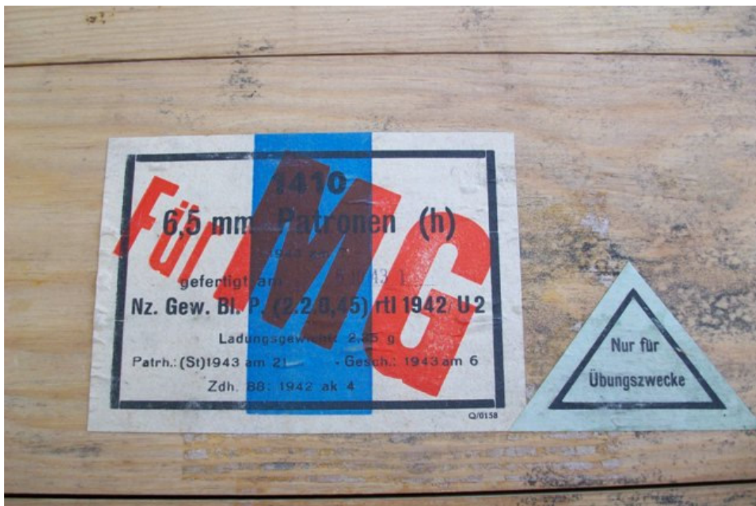
Afbeelding -3.12- De doosjes met Hirtenberger 6,5mm patronen werden per 1410 stuks in een houten kist verpakt. Opmerkelijk is het blauwe etiket (alleen voor oefendoeleinden). Code ak (slaghoedjes) staat voor Patr.-Zündh.-u. Metallwarenfabrik AG (Sellier & Bellot, vestiging Vlasim, Tsjecho-Slowakije). Foto Willem van Eijk.
