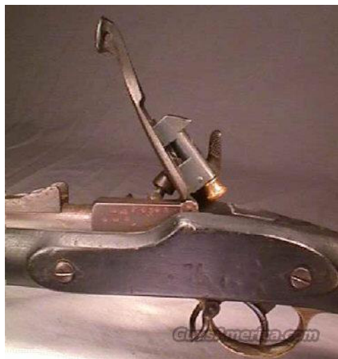
Afbeelding 6.3 Het Westley Richards Monkey Tail geweer met geopend sluitstuk. De ronde, messingkleurige plunjer sloot de kamer af. Op de voorzijde van de plunjer rustte de prop van vilt die tijdens de explosie uitzette en zorgde voor een gasdichte afsluiting. Afbeelding afkomstig van het Internet, http://GunsAmerica.com .
