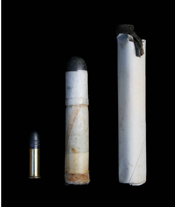
Afbeelding 6.4 Westley Richards papierpatroon. Geheel rechts is het lege papieren kokertje afgebeeld waarin de eigenlijke patroon, afgebeeld in het midden van de foto, werd bewaard. Links een .22 LR patroon ter vergelijking. De bruine prop van vilt, onderaan de patroon is goed zichtbaar. De prop zorgde voor een gasdichte afsluiting en werd bij het laden van de volgende patroon door de kogel de loop in gedruwd voor extra reiniging en smering. Collectie Jan van Gelderen.
