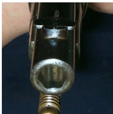
Afbeelding 6.11 Een loopmondig die is voorzien van de door Joseph Whitworth gepatenteerde hexagonale trekken en velden. Dit geweer is gemaakt door Thomas Turner of Birmingham, England, maar voorzien van een .451" Whitworth loop. Afbeelding afkomstig van Internet, http://www.imrl.org .
