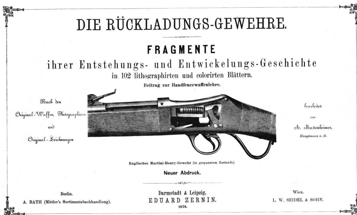
Afbeelding 1.1 De vorm van het vizier, de laad-handle en het achterste deel van de loop zijn identiek aan het geweer dat Frederich von Martini ter beproeving aan de Engelse overheid overhandigde. Het sluitblok op de afbeelding is echter langer. Dit is geen afbeelding van een militair Martini-Henry geweer. Voorblad van een verzameling van 102 lithografieën, gemaakt vanaf 1866.
