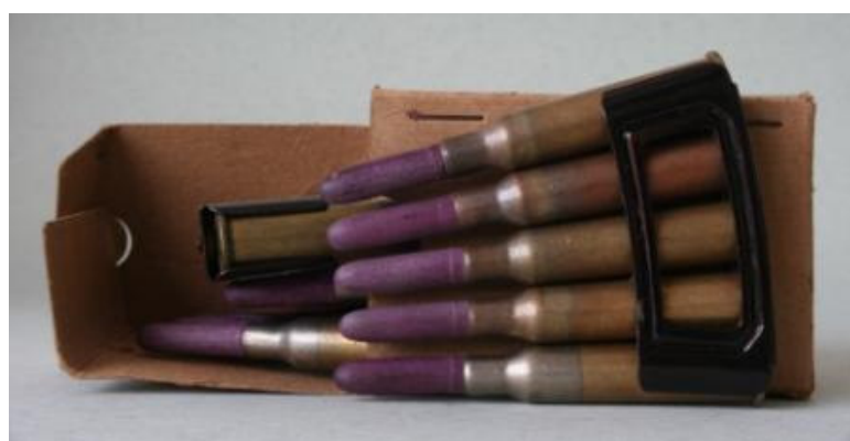
Afbeelding -1.10- t/m -1.14- Nederlandse 6,5 mm losse patronen, in 1943 verpakt bij het Belgische FN, bestemd voor buitgemaakte Nederlandse geweren in het Duitse leger. Het cijfer "13", zichtbaar in het bodemstempel van de huls geeft aan dat de huls gemaakt is in 1913 en de letter "B" is een aanduiding van het LOT messing waarvan de huls is gemaakt. De cirkel\letter "O" duidt aan dat deze huls is hergebruikt (herladen). Foto's J. van Gelderen, collectie B. Hendriks Franssen.
