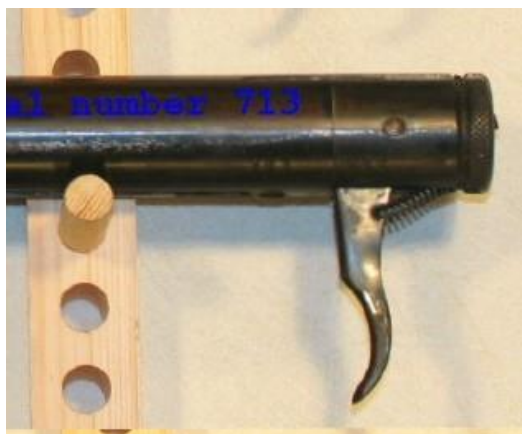
Afbeelding 5. Een heel vroege Weihrauch HW55 S uit 1950 met s/n 713. De trekker is tevens de haak waarmee de zuiger tegen de zuigerveer-druk wordt vastgehouden. Dit meest eenvoudige systeem wordt nog steeds toegepast maar is alleen geschikt voor luchtbuksen met een lichte zuigerveer. Collectie en foto Frank Korn.
