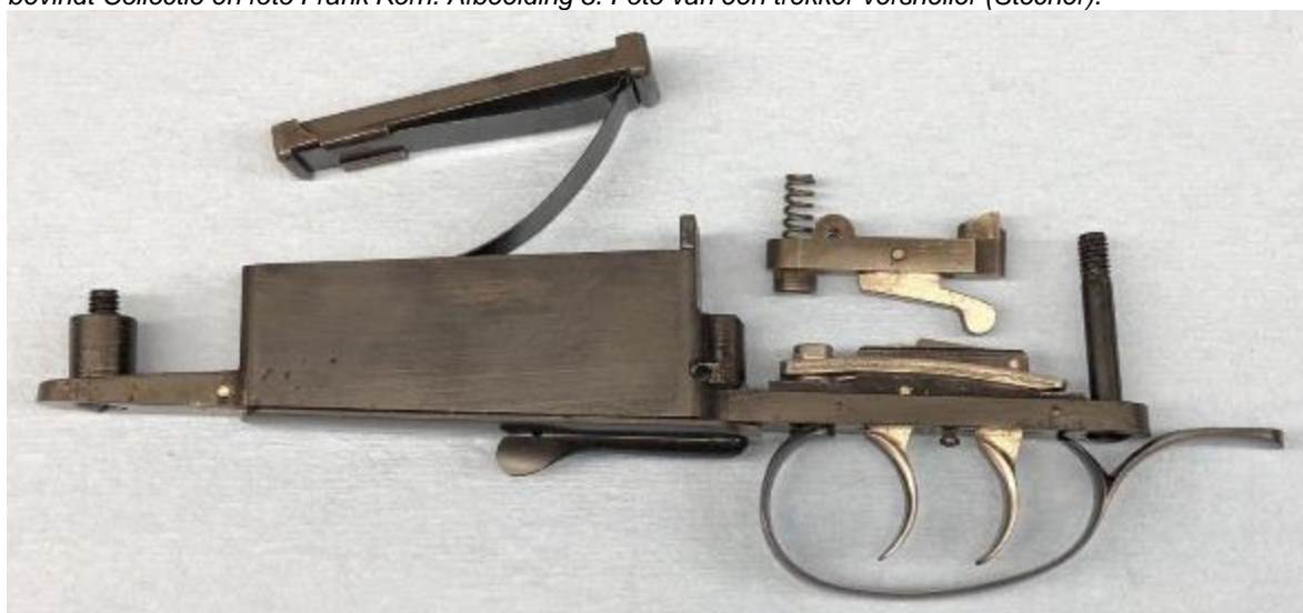
Afbeelding 9. De magazijnkast met het trekkermechanisme van het bekende Mauser Model 1898 grendelsysteem, maar voorzien van een trekkerversneller, identiek aan die van de Weihrauch HW55 MDT met s/n 8275. Het blijft een prachtig stuk techniek.
