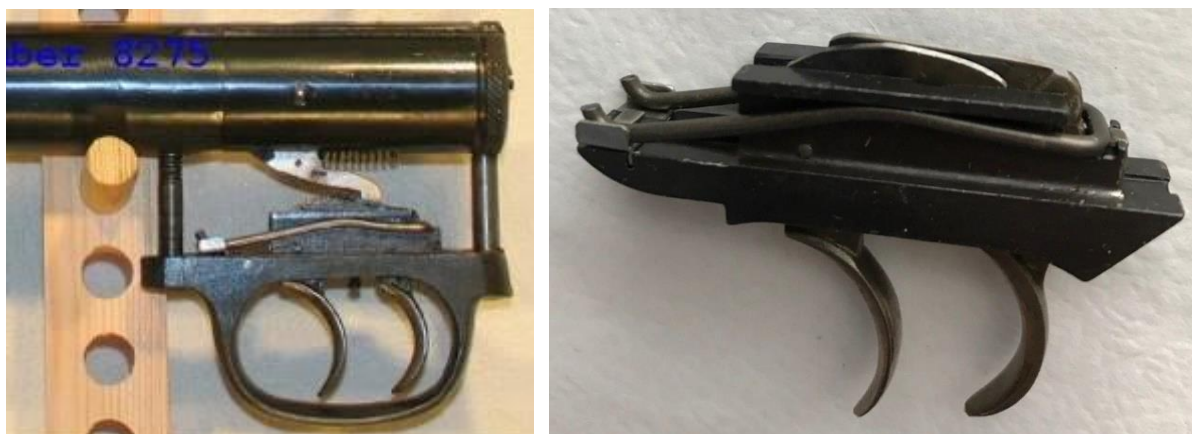
Afbeelding 7. Weihrauch HW55 MDT met s/n 8275. Bouwjaar 1955 (?) voorzien van een trekker versneller (Stecher). De grote kracht van de hoofdveer wordt tegengehouden door het onderdeel dat zich boven de stecher bevindt Collectie en foto Frank Korn. Afbeelding 8. Foto van een trekker versneller (Stecher).
