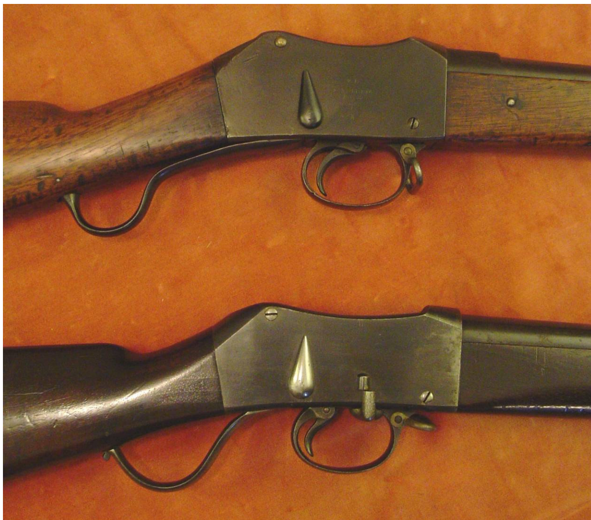
Afbeelding 3.2 Het bovenste geweer is een Martini-Henry MK I third pattern. Een dergelijk geweer zal u niet vaak aangeboden worden. Het onderste geweer is nog veel zeldzamer. Dit is een van de 200 geweren met een lang sluitstuk. In de literatuur en op Internet worden deze geweren ook wel aangeduid als “Long Chamber rifles”. De pen tussen de trekker en de riembeugel is de veiligheidspal. Een dergelijke veiligheidspal komt ook voor op de Martini-Henry Mk I first pattern en de MK I second pattern. Collectie Jos van Helden en Rob Thissen.
