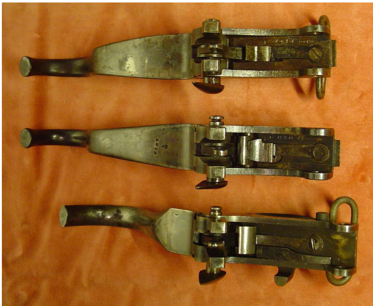
Afbeelding 3.13 Engelse High Tech uit 1870. Het onderste trekkersysteem is afkomstig van de Martini Long Chamber rifle. Dit trekkersysteem is voorzien van het eerste type tumblerrest zoals deze ook voorkomt op de Martini-Henry MK I first pattern. Het middelste trekkersysteem is afkomstig van een Martini-Henry MK I third pattern. Het bovenste trekkersysteem beschikt over de tumbler met verlengde arm zoals dat op de Martini-Henry Mark II en alle latere modellen voorkomt. Collectie Rob Thissen en Jos van Helden.
