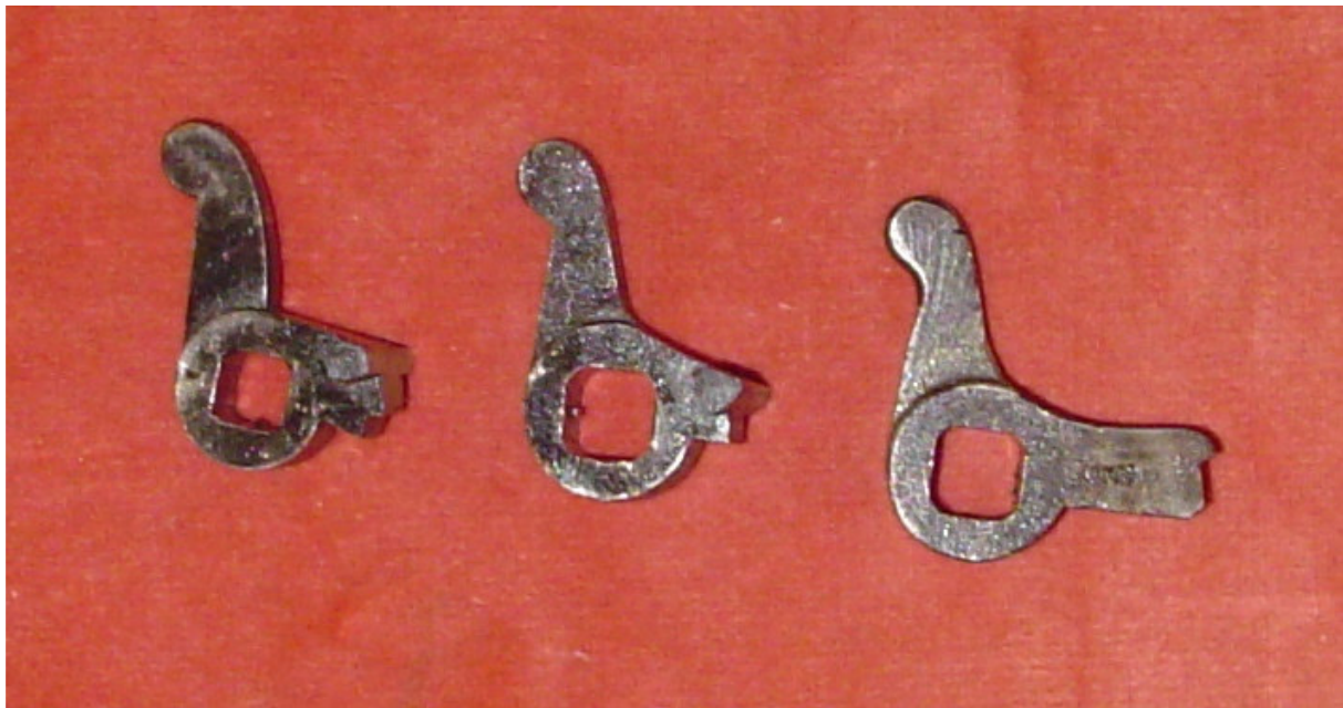
Afbeelding 3.12 De ontwikkelstadij van de tumbler. Links; M-H MK I first pattern: Het eerste model tumbler dat werkt in combinatie met de tumbler rest. Midden; M-H MK I first en second pattern: Het tweede type tumbler werkt in combinatie met de gemodificeerde tumbler rest. Let op het ronde vlak aan de rechter zijde van de tumbler. Dit vlak wordt in gespannen toestand tegengehouden door een overeenkomstig afgerond vlak van de gemodificeerde tumbler rest. Aan de voorzijde is de gemodificeerde tumblerrest voorzien van een nok die ingrijpt op de trekkernok. Bekijk, ter verduidelijking, ook afbeelding 3.10. Rechts; M-H Mk II en latere modellen: Door de tumblerarm te verlengen werd de druk op de trekkernok verlaagd door de momentwerking. Collectie Rob Thissen en Jos van Helden.
