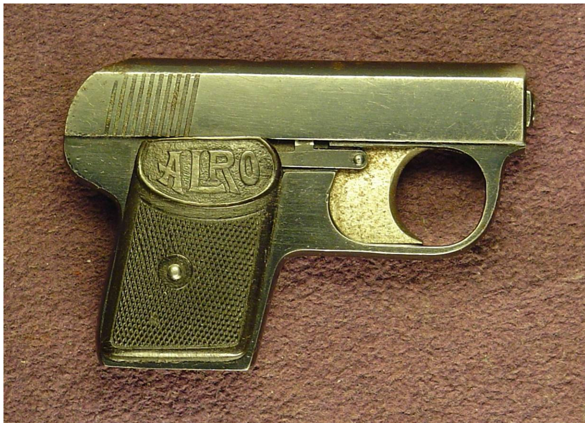
Afbeelding 1.1 Dit pistool is gefabriceerd door ALRO. Het wapen is geheel gemaakt van staal met uitzondering van de kunststof greeplaten. Het magazijn kan 8 patronen bevatten. Afmetingen: 11 cm x 7 cm x 1,5 cm. Collectie Jan van Gelderen.
