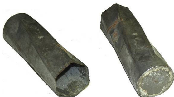
Afbeelding 3.8 Afbeeldingen van de patroonhuls van het 12 ponders Whitworth achterlaadkanon. Op de rechter afbeelding is het centrale vlamgat zichtbaar voor de ontsteking door middel van een separaat slagpijpje. De huls werd met de hand gemaakt van staalplaat. Aan de achterkant is zichtbaar dat de wanden zijn omgevouwen tegen de bodemplaat. Foto gepubliceerd met toestemming van Jack Melton Jr.
