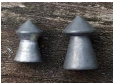
Afbeelding – 20 en 21 - H&N (Haendler & Natermann) spitzkugel, kal 4,5 mm met een gewicht van 0,56 gram en H&N spitzkugel, kal 5,5 mm met een gewicht van 1,04 gram. Het blijft opvallend dat slechts 1 mm verschil in diameter van de kaliber 4,5 mm ten opzichte van kaliber 5,5 mm diabolo's maakt dat de kogel bijna 2x zo groot is en bijna 2x zoveel weegt. Weihrauch maakte in die tijd nog geen luchtgeweren in kal 6,35 mm.
