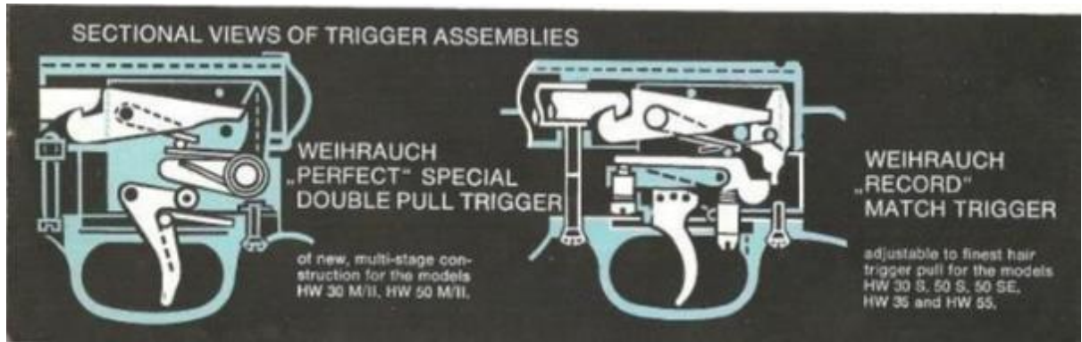
Afbeelding - 15 - De zuigerveer van de HW50 is te krachtig om de vangpal met de trekker te combineren tot 1 onderdeel, zoals dat met de HW25 het geval is. De HW50 M/II is daarom voorzien van een meertraps "PERFECT" trekkermechanisme. De wat luxere HW50 S, alle HW35 luchtgeweren en de duurdere huidige modellen zijn voorzien van het verstelbare "RECORD" trekkermechanisme. Afbeelding afkomstig van Frank Korn.
