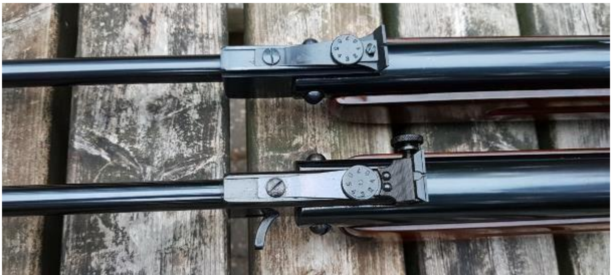
Afbeelding - 16 - Het vizier van de HW50 M/II was destijds nog geheel van staal en voorzien van een eenvoudige sleufschroef voor eenvoudige zijdelingse verstelling. Detail: het vizierblad waarin de keep is aangebracht is gematteerd. Het vizier van de HW35 is wel zijdelings fijn verstelbaar met klikken. Dat onderdeel is gemaakt van Zamak.
