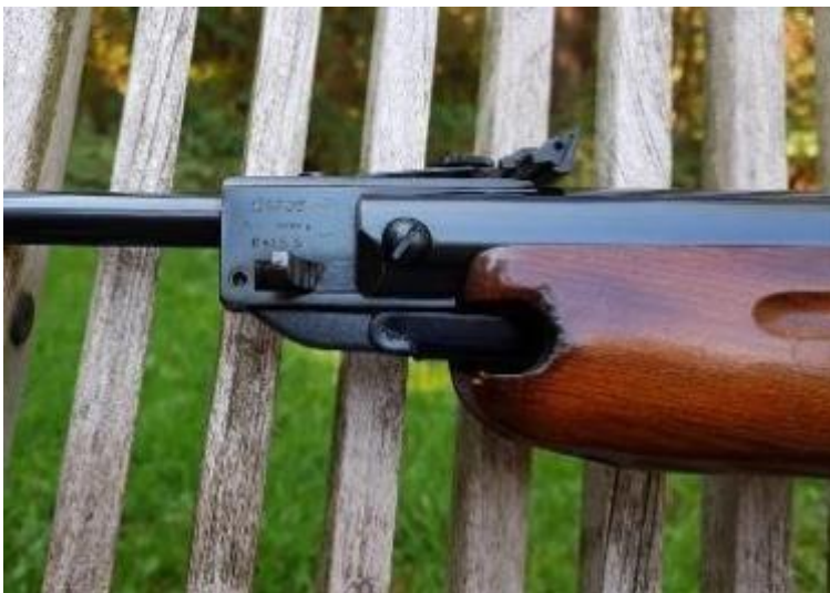
Afbeelding - 8 - De kal 5,5 mm HW35. Een nadeel van de handmatige loopblokkering is het lelijke gat in de kolf dat nodig is om ruimte te bieden aan de duimpal. Opvallend is dat dit systeem op geen enkel ander model is toegepast. De HW55 had een handmatige loopblokkering die anders was uitgevoerd en de HW55 wordt al decennia niet meer gemaakt. Toch is de handmatige loopblokkering al wel 67 jaar ononderbroken een standaard onderdeel van elke HW35. Alle andere luchtgeweren hebben de verende loopvergrendelingsnok zoals die is
