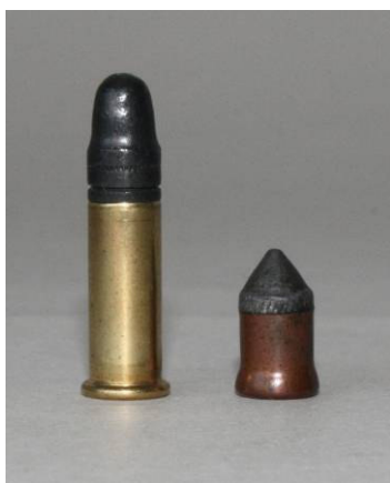
Rechts op de foto een afbeelding van een vroeg model 6 mm Flobert patroon. Let op de conisch toelopende rand van de huls. De rand heeft de tapse vorm zoals Louis Nicolas Auguste Flobert deze aanvankelijk gebruikte. Pas later zou de rand de uitgestulpte vorm krijgen zoals we die kennen van de moderne .22 Long Rifle (ter vergelijking links op de foto afgebeeld). Het kwikzilver werd over het gehele oppervlak van de hulsbodem aangebracht. Tijdens de percussie werd de gehele achterzijde van de hulsbodem ingedeukt, dus niet alleen de rand. (Collectie Jan van Gelderen)
