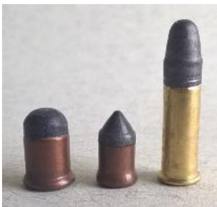
Afbeelding 1.03 Links op de foto een afbeelding van een vroeg model 7 mm Flobert patroon met daarnaast een kaliber 6mm Flobert patroon.. Let op de conisch toelopende rand van de huls. De rand heeft de tapse vorm zoals Louis Nicolas Auguste Flobert deze aanvankelijk gebruikte. Pas later zou de rand de uitgestulpte vorm krijgen zoals we die kennen van de moderne .22 Long Rifle (ter vergelijking rechts op de foto afgebeeld). Het slagsas werd over het gehele oppervlak van de hulsbodem aangebracht. (Collectie Jan van Gelderen, lid van NVBMB)
