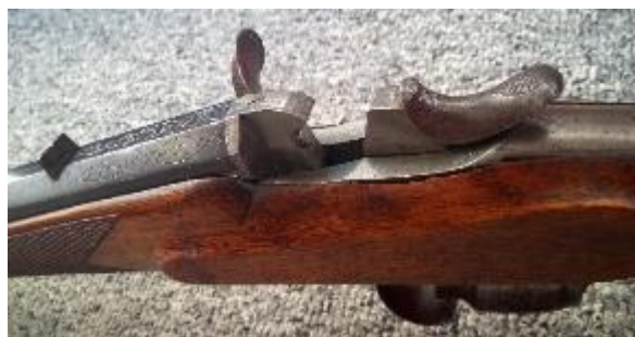
Afbeelding 1.21A Een, op het eerste gezicht normaal kal. 6 mm Flobert geweer. De vergrendeling is echter afwijkend waardoor dit systeem vaak wordt aangegeven als systeem Remington. Dit is vanwege de gelijkenis met het Remington Rolling Block systeem.
