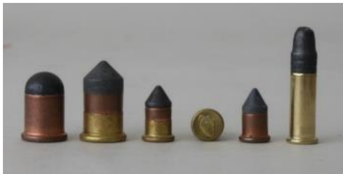
Afbeelding 1.11 Foto met van links naar rechts: 9mm Flobert met rondkogel, 9mm Bosquette met spitskogel, 6mm Bosquette, hulsbodem van een 6mm Bosquette, 6mm Flobert met spitskogel en geheel rechts een .22 Long Rifle ter vergelijking van de afmetingen. (Collectie Jan van Gelderen, lid van NVBMB)
