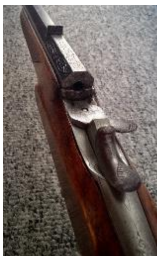
Afbeelding 1.21A Een, op het eerste gezicht normaal kal. 6 mm Flobert geweer. De vergrendeling is echter afwijkend waardoor dit systeem vaak wordt aangegeven als systeem Remington. Dit is vanwege de gelijkenis met het Remington Rolling Block systeem.
