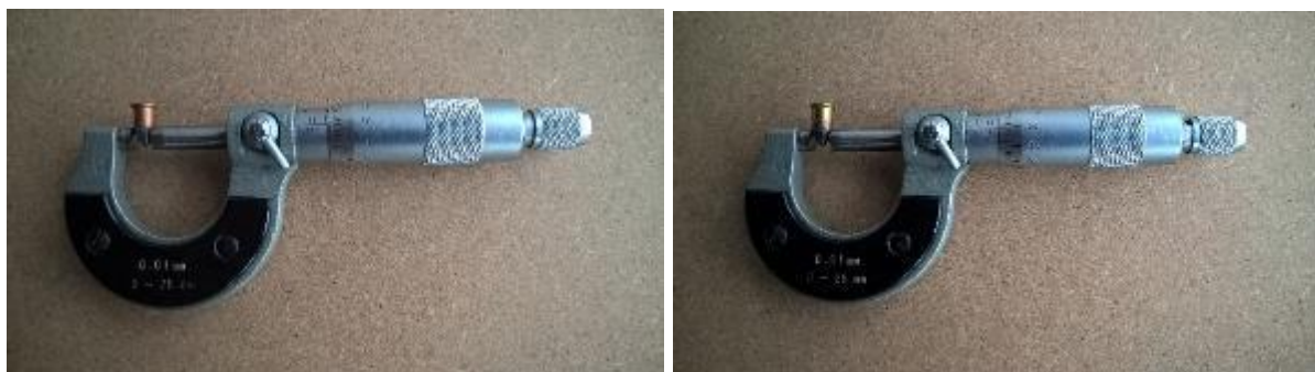
Afbeeldingen 1.09 en 1.10 Linker foto: 6 mm Flobert met puntkogel. De diameter is 5,60 mm. Rechter foto: 6 mm Bosquette. De diameter is 5,85 mm, dus een afwijking van 0,02 mm ten opzichte van het exacte kaliber 5,87 mm.
