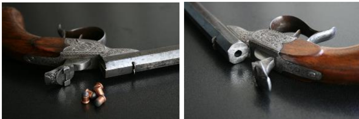
Afbeelding 1.06A-, en 1.06B. De sterke slagveer in combinatie met de zwaar uitgevoerde haan van dit vroeg model Flobert pistool zorgen voor de vergrendeling tijdens het schot. Op de haan is duidelijk de horizontale strook zichtbaar die een inslag maakt over de gehele breedte van de hulsbodem. Links en rechts van deze strook zijn 2 haken zichtbaar die de afgeschoten patroonhuls uit de kamer moeten trekken. De constructie van deze haan komt overeen met de tekening van patent nummer 8618, van 23 mei 1849. De haken die de patroonhuls uit de kamer moesten trekken waren kwetsbaar en haakten soms niet om de hulsrand heen waardoor de huls in de kamer achterbleef.
