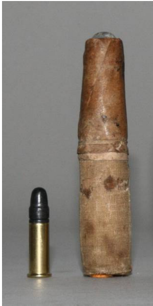
Foto van een Chassepot naaldvuur patroon. Links, ter vergelijking van de afmetingen, een .22 LR patroon. (Collectie Jan van Gelderen)
