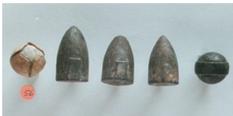
Afbeelding 1.6 Kogels voor het Brunswick geweer. De uitwendige groeven pasten in de twee trekken van de loop. De kogels waren dus passend en daarom was het niet nodig om de kogel tijdens het laden te vervormen. De linker kogel is voorzien van een patch. Foto gepubliceerd met toestemming van Franco Widmer ( http://www.ch-munition.ch ).
